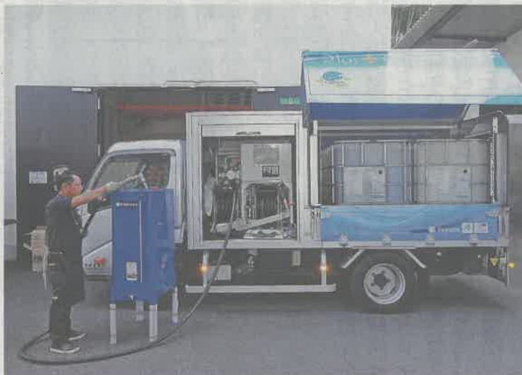
コンテナを積み込んだ配送車から小型ポンプでタンクに給油する。タンクは顧客の店舗に無料で設置し、巡回しながら量り売りする。京都市山科区・FUKUDA
